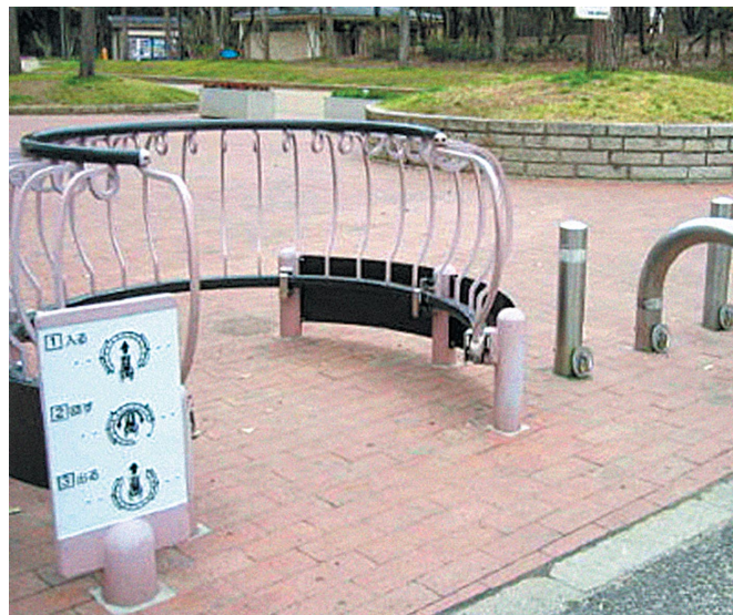
6.4.1b) 旋转门栅作为轮椅/手推车使用者的入口
