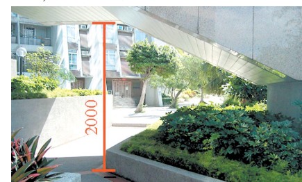
6.7.1j) 使用植物盆栽，防止行人在楼梯底净空高度少于2000毫米的部份行走
