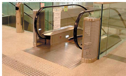
6.7.2d) 安装触觉警告带
