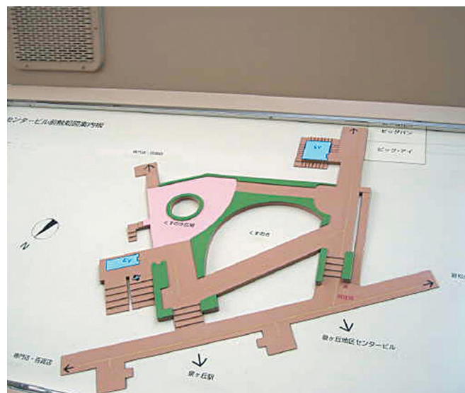
6.8.3b) 显示如何通往建筑物之凭触觉使用和有点字地图
