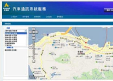
工地设有车载式全球卫星定位系统，监察及防止非法倾倒废物
