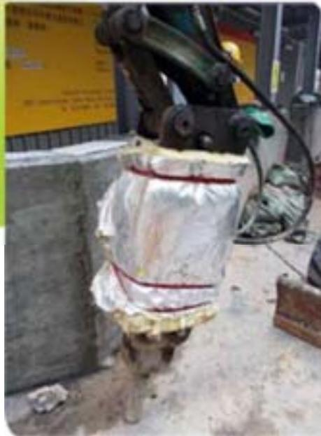
破碎机隔声套<sup>3</sup>
