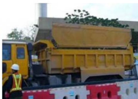
泥頭車用機械閘封蓋
