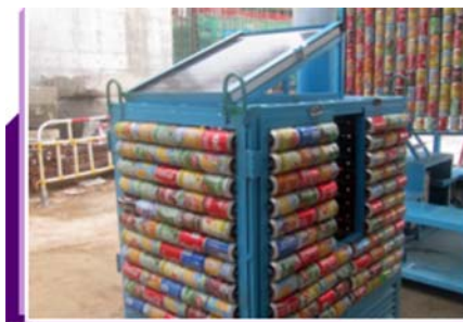
裝有太陽能光伏板的流動飲水機
