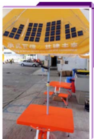
利用太陽能光伏板發電驅動風機
