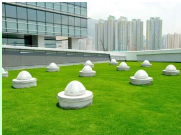
日光導管在社區會堂天台採集陽光(左)，透過高反光度的內層(右)將光線傳到多用途練習場
