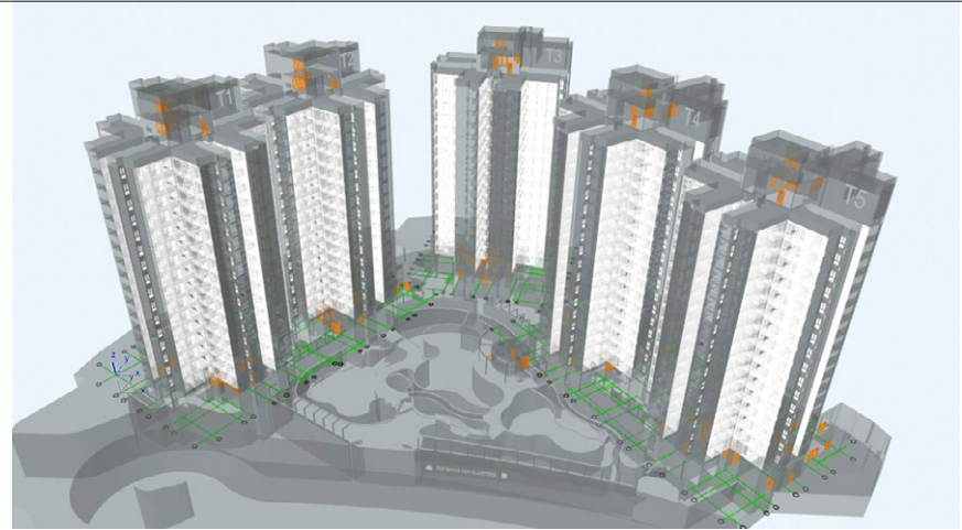
此项目由设计到建造皆采用建筑信息模拟技术及「组装合成」建筑法
