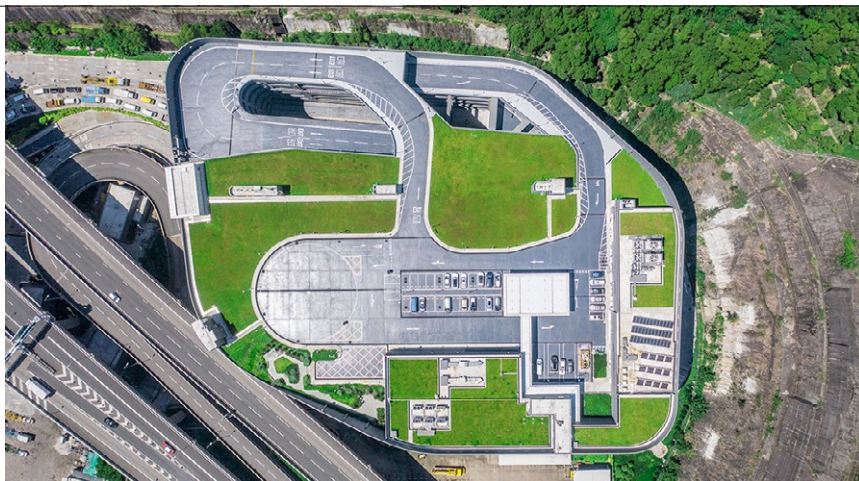
采用屋顶绿化，减低热量传递
