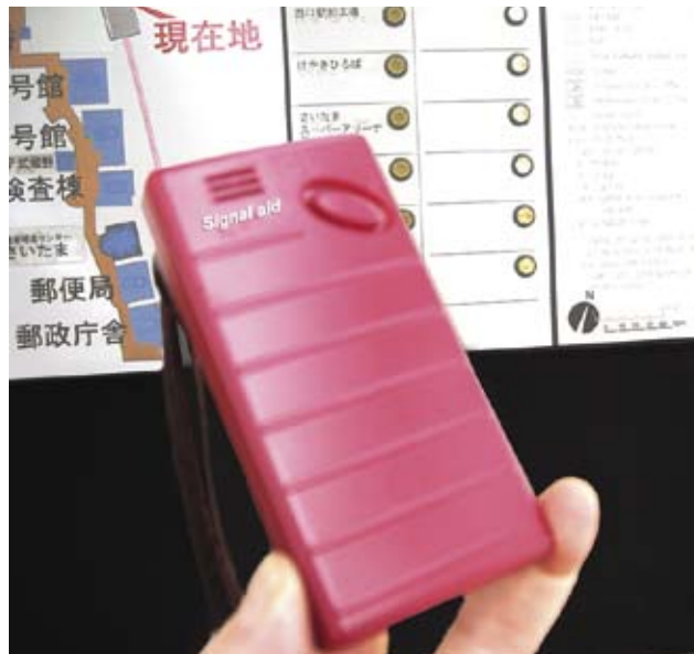
3.5.5.2b 話音資訊系統利用電子指示牌傳送訊號至手提終端機
