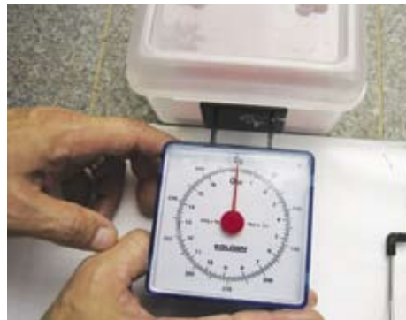
iv) 把測試箱置於平坦的測試鋪地物料上，把磅緊貼測試箱正面，然後把磅的讀數調至零
