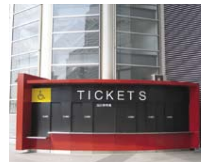
4.5f 大型標誌以顏色對比鮮明的國際通達符號標示通達服務櫃檯
