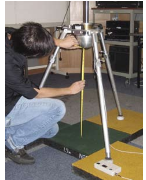
3.4.2.4.h 选择合适的地垫，应根据缓撞性能(如上图所示)而非地垫标称厚度来取舍
