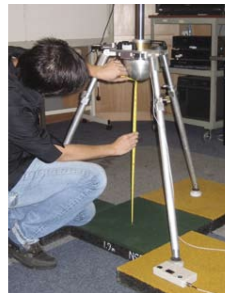
3.4.2.4.h 选择合适的地垫，应根据缓撞性能（如上图所示）而非地垫标称厚度来取舍
