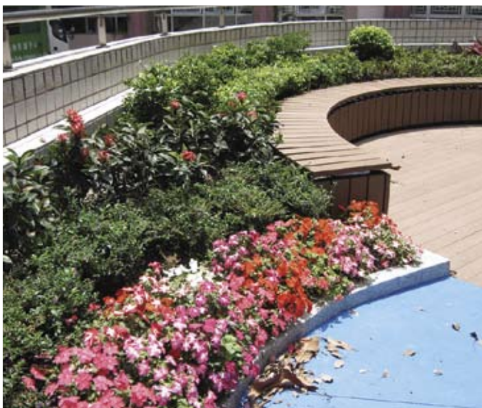
3.5.5.3a 散发香气的植物可作为嗅觉提示，让使用者确定位置
