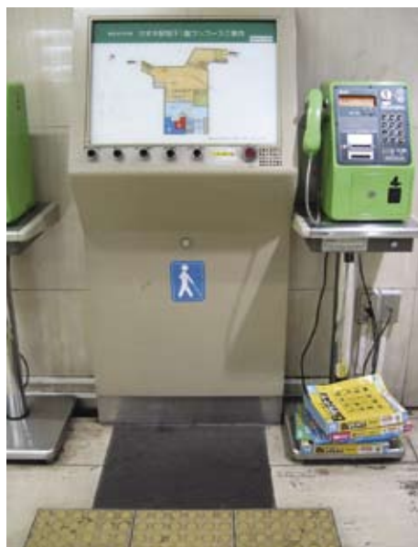
3.5.4.6a 触觉引路带通往兼备声频及点字资讯的指南
