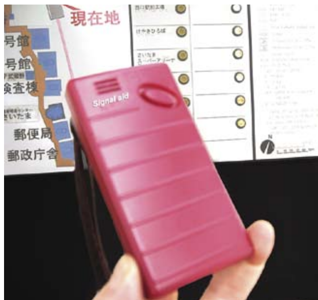
3.5.5.2b 语音资讯系统利用电子指示牌传送讯号至手提终端机
