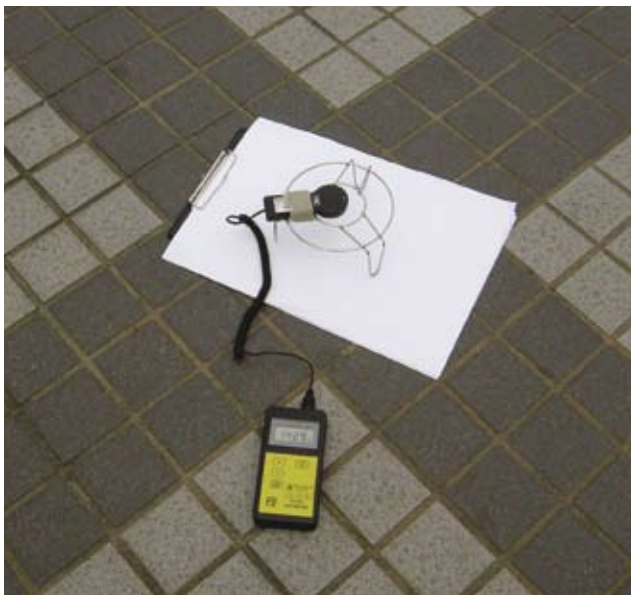
3.7.5.2a 以白纸录取的数据(Ln勒克斯)会与测光面录取的读数(L勒克斯)作比较
