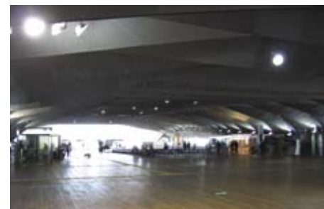
3.8.4.2b 深邃、楼底较矮、欠缺天然光线的建筑物，犹如隧道，应采取措施让眼睛适应骤变的照明度
