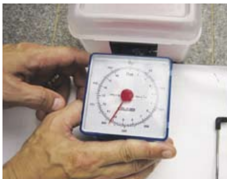
v) 把磅推向测试箱，并逐渐加大力度，直至测试箱刚开始移动
