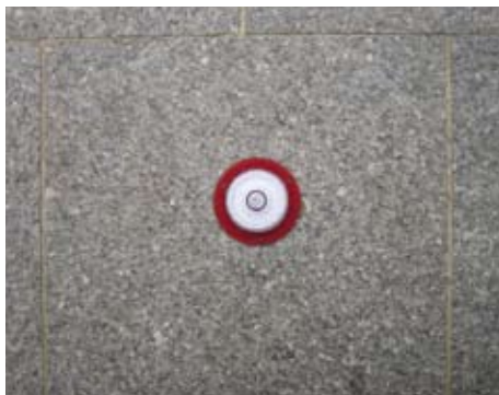
ii) 在测试前检查地面的水平度
