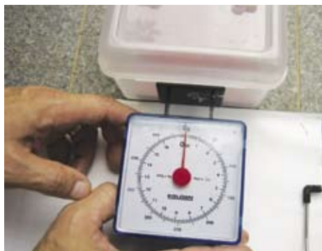
iv) 把测试箱置于平坦的测试铺地物料上，把磅紧贴测试箱正面，然后把磅的读数调至零
