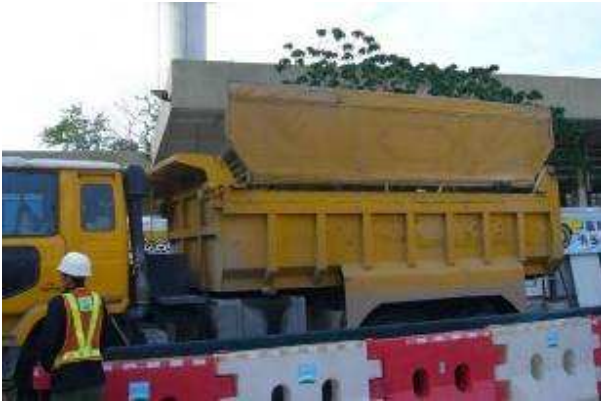
图6. 运泥车上的机械盖在离开地盘前必须关闭
