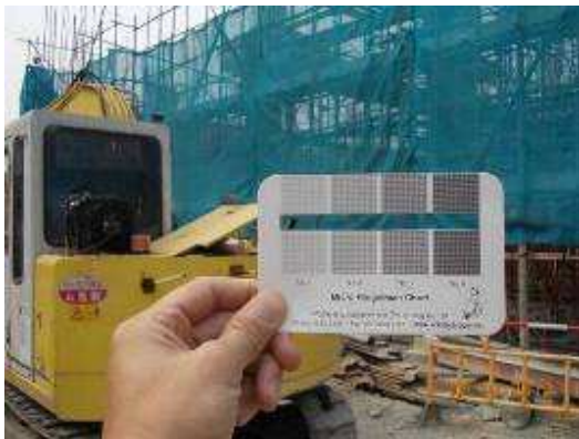
圖4. 使用林格曼圖進行機械黑色煙霧監測
