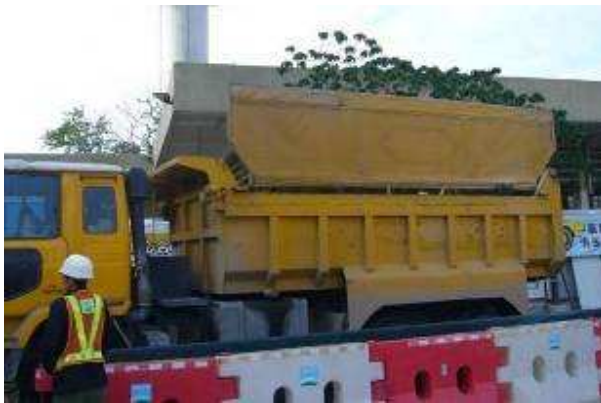
圖6. 運泥車上的機械蓋在離開地盤前必須關閉
