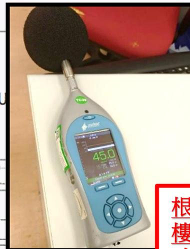
根據實地到K座大樓測量，噪音指數由約50分貝降至45分貝。證實隔音屏障有效阻擋噪音。
