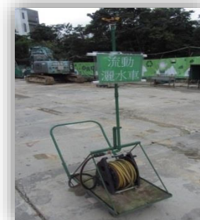
使用废弃铁枝制作固定或降尘装置
