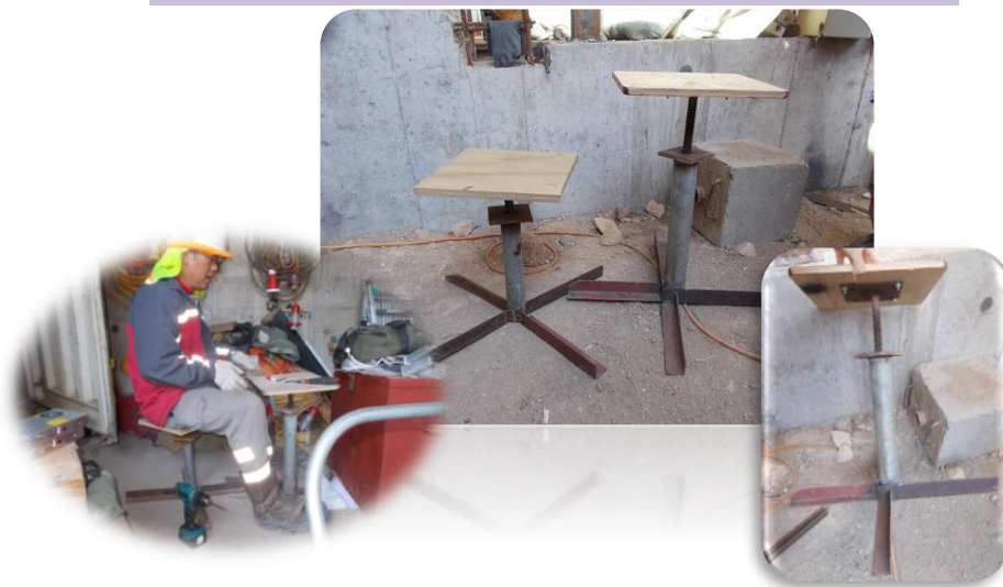
使用废弃铁枝制作固定或降尘装置
